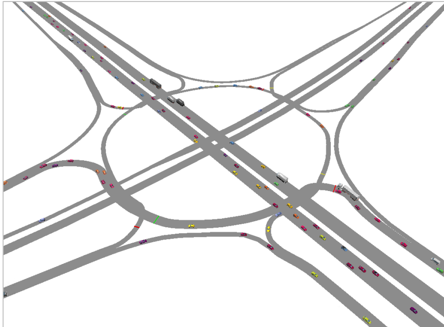
VISSIM: gedetailleerde simulatie verkeerssituatie op individueel voertuigniveau
