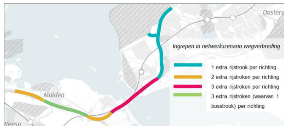
Figuur 2 Onderzochte wegverbreding A1 en A6 in het bereikbaarheidsonderzoek 2021 (Goudappel & Royal HaskoningDHV)
